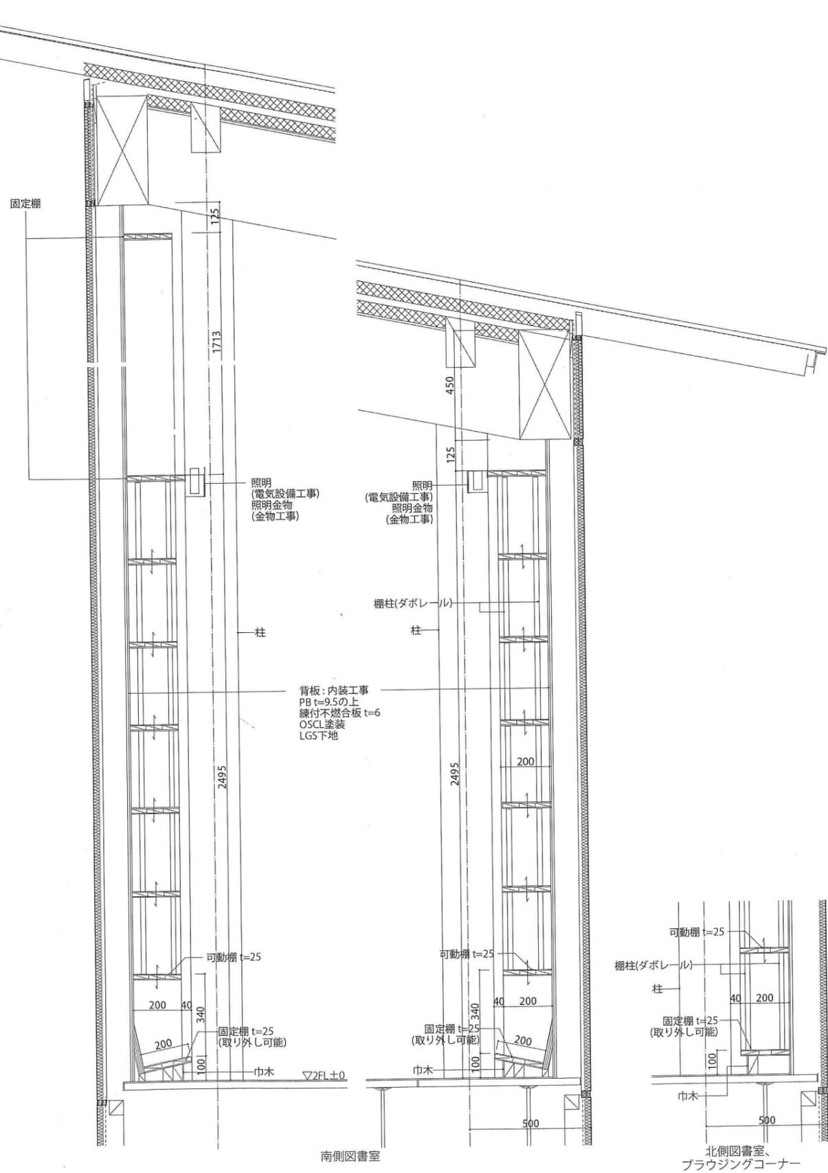
造作工事本棚1 基準断面図 S=1/10
