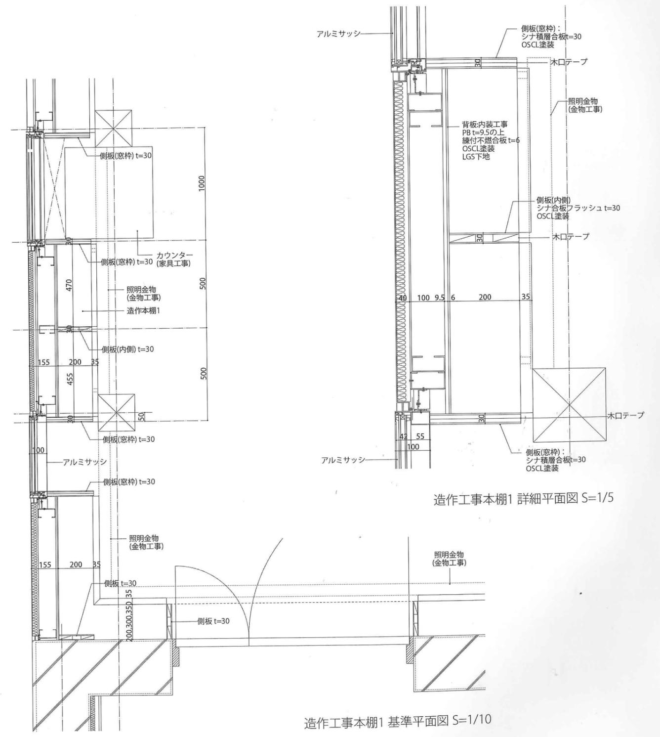
造作工事本棚1 詳細平面図 S=1/5
